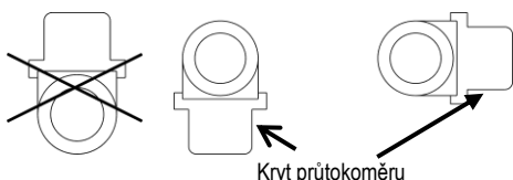
Obr. 4: Doporučená montážní poloha pro měření chladu
